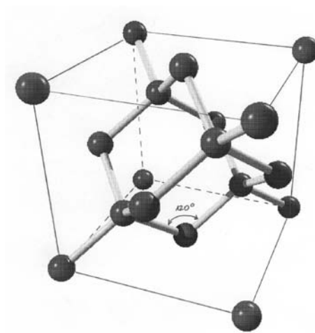
a) osnovna celica silicija z vsemi atomi
